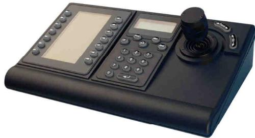
Die Tastatur der IntuiKey Serie ist eine multifunktionale Tastatur mit vollem Funktionsumfang zur Systemsteuerung und -programmierung. Sie ist spritzwasserfest und mit einem integrierten Joystick für das Schwenken, Neigen und Zoomen mit variabler Geschwindigkeit ausgestattet. Mit einem optionalen Rackmontagesatz kann IntuiKey in ein 19-Zoll-Standard-EIA-Rack (48 cm) eingesetzt werden.
