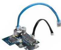
Ethernet auf SFP-Konverter für TCP/IP Ausführungen der VG4/VG5-Autodome | Einbau in Netzteilgehäuse VG4-A-PA2 oder VG4-A-PSU2 | Spannungsversorgung durch Kamera | geeignet für 10/100 Mbps SFP-Module (separat bestellen) | Kompatibler Empfänger CNFE2MC/IN | Abmessungen 7.4 x 7.1 x 3.8 cm | Gewicht 0,91 kg
