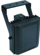
IR Strahler 850nm   medium range   wechselbarer Abstrahlwinkel/Reichweite:<br>10°/220m, 20°/150m, 30°/110m, 60°/70m, 80°/50m, 95°/35m   12-32VDC oder 24V AC   26W | A 1A            | 492,66           |
