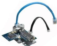
Ethernet auf SFP-Konverter für geeignete Netzteilgehäuse | Einbau in Netzteilgehäuse VG4-A-PA2, VG4-A-PSU2, NDA-U-PAx, NBA-7070-PAx | Spannungsversorgung durch Netzteilgehäuse | geeignet für 10/100 Mbps SFP-Module (separat bestellen) | Kompatibler Empfänger CNFE2MC/IN | Abmessungen 7.4 x 7.1 x 3.8 cm | Gewicht 0,91 kg
