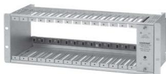
19"-Rahmen für maximal 14 CNFE2MC/IN Module | Spannungsversorgung 90-264 VAC bei 1 A | Versorgungsspannung für SFP-Module 9 VDC ± 5% bei 6.5 A | Abmessungen (LxWxH) 48 x 19 x 15 cm | Gewicht 3.4 kg
